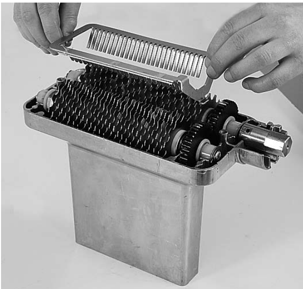
Rys. 6. Demontaż elementów modułu
