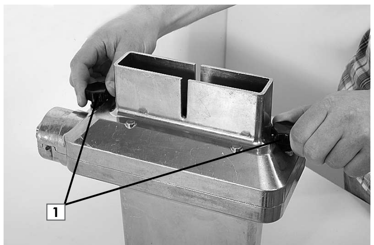
Rys. 4. Rozbieranie modułu kotleciarki
