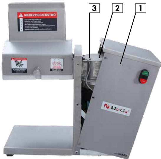
Rys. 8. Demontaż obudowy maszyny
