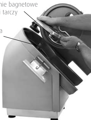
Rys. 11) Mocowanie tarczy na wałku
